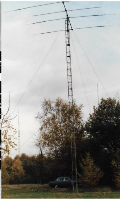
4 elementen YAGI (Korte golf : 20/15,10m banden)
